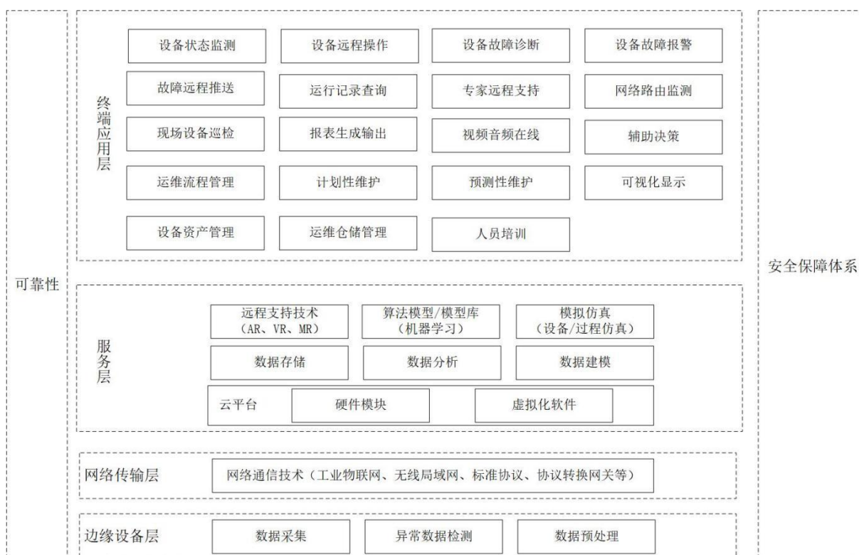
图1 远程控制与数据传输框架模型
